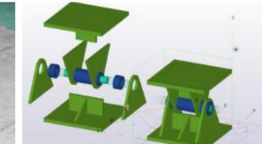
地震の揺れにより、アンカーボルトに引き抜きのテンションが発生。その結果、屋根を支える土台のコンクリートが破損する被害が発生しました。九州第一工業では免振効果を発揮するピン支承システム『DI式スペースパック（ピン柱脚）』を自社開発しご提案を行っております。
