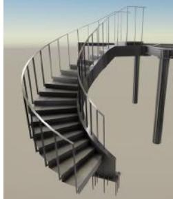
難点は2つ「片持ささら（片側だけの階段の側面プレート）で強度が確保できるか？」、「3次元の曲げ加工ができるか？」。さらさら片持ささらにするには、プレートでは強度が持たない問題の解決は「プレートを合せて、箱型にしたら持つんじゃない？」と言う発想が持ち上がり、早速BIMでモデリングを開始し、3Dでイメージが完成！それを3Dプリンターで模型にするところまでが完成しました。さて、ここからが最大の難題「3次元の曲げ加工ができるか？」と言う問題。プレートを3次元曲げ加工し、それをボックスに加工する方法に関して、手探りで曲げ試験を繰り返し、ついに問
